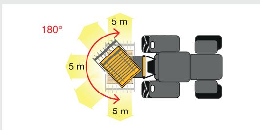
**Projecteur de paille rétractable hydrauliquement :** paillage à droite/gauche/centre sur 5 m.
