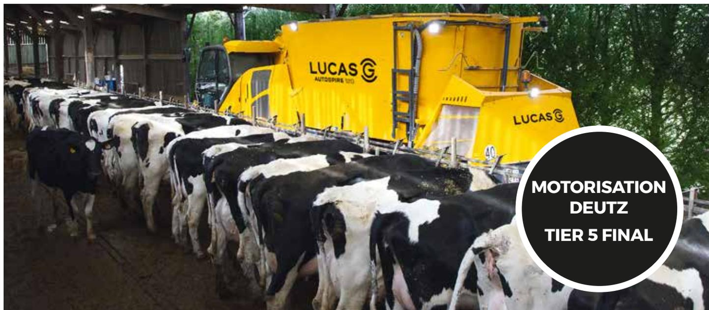
La mélangeuse automotrice Autospire a été conçue pour réaliser une tournée quotidienne de plus de 70 km par jour. Les machines sont équipées de pneus poids lourds larges et d'un système de freinage à 4 freins à disque pour une tenue de route et une sécurité optimale à 40 Km/h. La suspension hydropneumatique avant et par lame parabolique arrière procure souplesse et confort de conduite pour l'opérateur.
