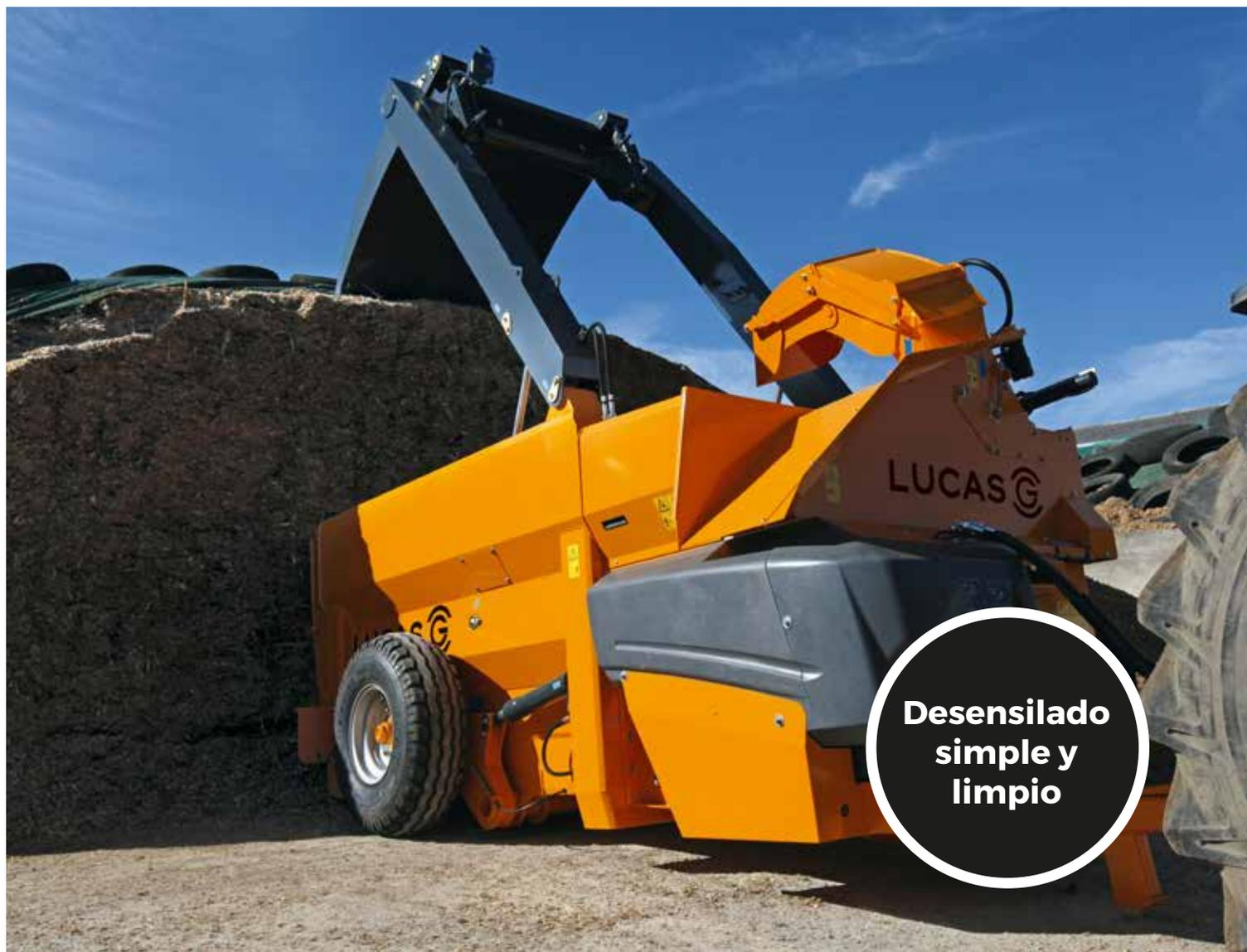
La gama de desensiladoras distribuidoras encamadoras Castor G se compone de cuatro modelos de 4 hasta 8 m<sup>3</sup>. El brazo de desensilado redondeado permite una carga simple y limpia de los silos, una vez la máquina cargada, la distribución se efectúa por la turbina. Las desensiladoras distribuidoras encamadoras Castor G pueden ser equipadas con una tolva de mezcla para los alimentos secos para la adición de complementos a la ración.
