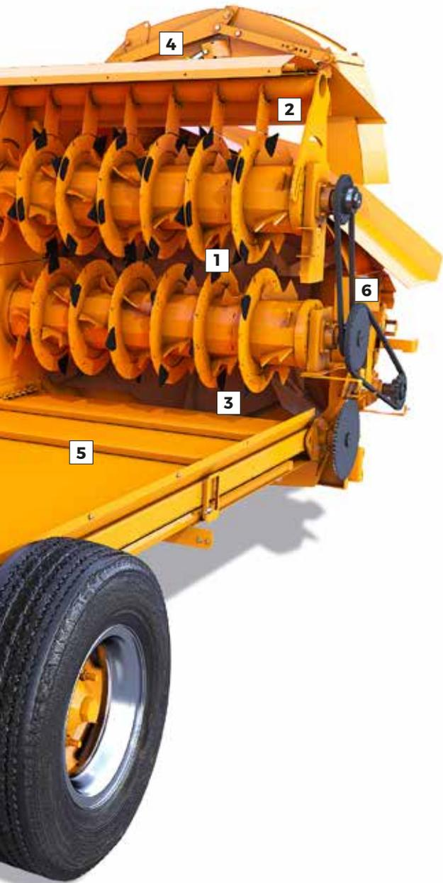
**5 Fondo de transporte atornillado:** accionado hidráulicamente, posee 9 velocidades de alcanza de 0 hasta 20 m/min. La velocidad se ajusta con el mando eléctrico, lleva con regularidad la materia al picador. Puede ser accionado hacia adelante o hacia atrás.
