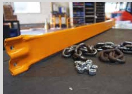
Fond mouvant avec attache rapide en U boulonné pour un entretien facile.
