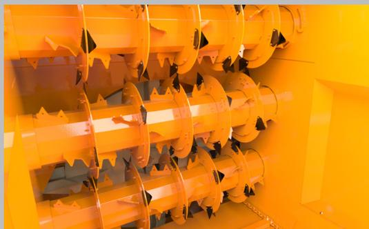
3 picadores accionados mecánicamente equipados con secciones de corte en forma de V y con discos lisos para permitir un corte neto y preciso de todos los forrajes incluso los más difíciles (hierba humedad).
