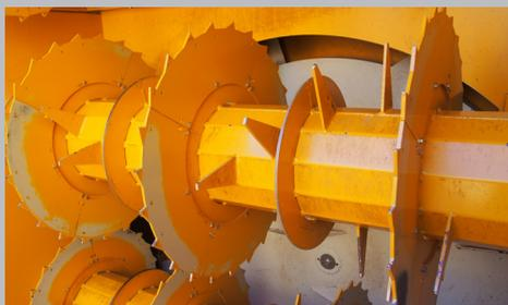
Démêleurs entraînés mécaniquement par un jeu de chaînes avec boulon de sécurité, ils sont équipés de 7 disques dentés conçus exclusivement pour la coupe de la paille.
