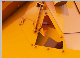
Abgeschrägtes Teil, befindet sich im Auswurf, dieses Teil sichert eine homogene Einstreuung und ohne Verklümmung.
