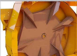
Dieses Teil ist konzipiert aus einem Block mit einem Durchmesser von 2200mm ausgestattet mit 8 Gebläseschaufeln für eine perfekte Stabilität beim Mulchen in hoher Geschwindigkeit.
