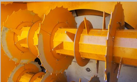
Mechanisch angetriebene Auflösewalzen durch ein Kettensatz mit Sicherheitsbolzen, sie sind mit 7 Zahnscheiben ausgestattet speziell für das Auflösen von Stroh.
