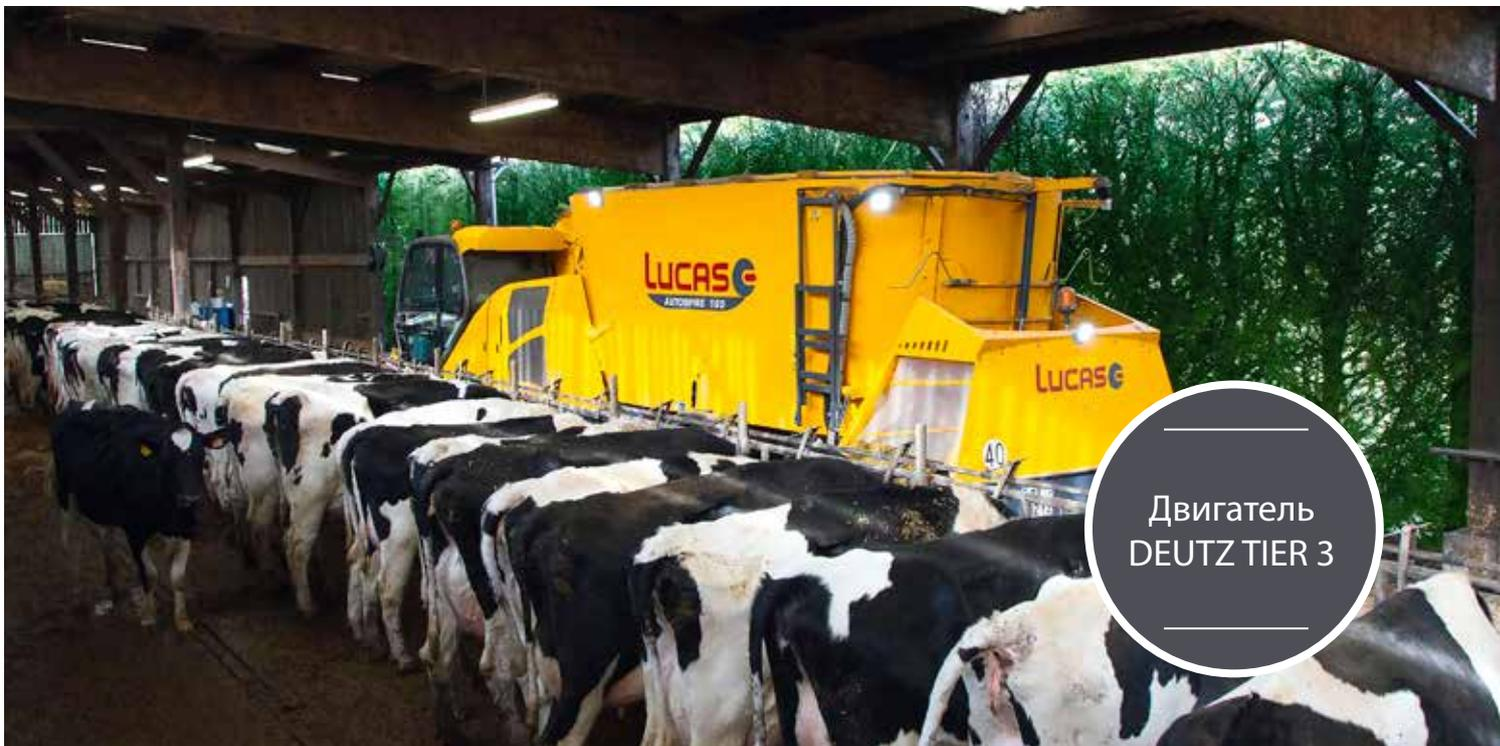
Самоходный кормосмеситель Autospire спроектирован для возможности ежедневных поездок на расстояние более 70 км. Машины оснащены широкой грузовой резиной и дисковой системой торможения на 4 колеса, для хорошей устойчивости на дороге и оптимальной безопасности при 40 км/час. Передняя гидропневматическая подвеска и задняя параболическая подвеска обеспечивают гибкость и комфорт для водителя.
