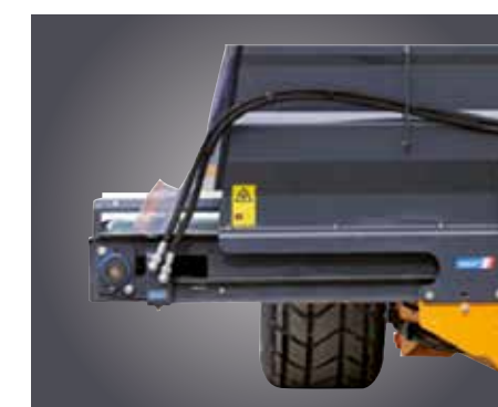
Вынос конвейера раздачи гидравликой
