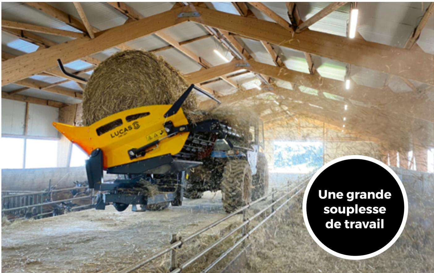
Les dérouleuses pailleuses UBI Jet et UBI Jet Disk sont des machines polyvalentes avec une rotation à 180° pour la distribution et le paillage des bâtiments. Ces machines sont équipées de série d'une caisse inclinable pour permettre un déroulage performant de foin, paille, enrubannée, luzerne et d'un bras de chargement à réglage hydraulique pour s'adapter à différentes tailles de bottes. Ces machines peuvent être attelées à l'arrière du tracteur ou sur la flèche d'un télescopique.
