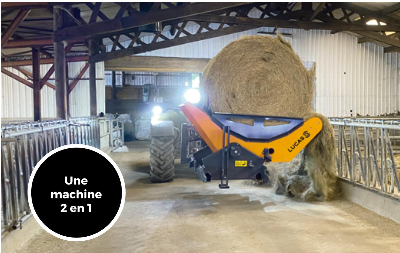
Les dérouleuses UBI PIC et UBI PIC FIX sont des machines 2 en 1 qui nécessitent uniquement l'utilisation d'un chargeur frontal ou d'un chargeur télescopique pour effectuer un déroulage efficace d'une botte de foin, paille, enrubbannée ou luzerne. La différence entre ces deux machines est que la version UBI PIC possède une inclinaison de caisse. Ces machines s'attèlent à l'avant d'un chargeur frontal, d'une chargeuse articulée ou d'un télescopique. De série, la machine distribue à l'avant gauche.
